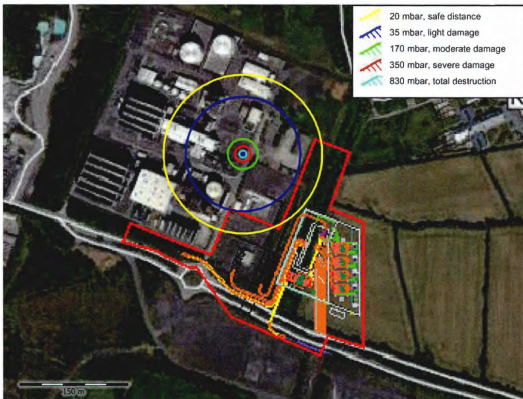
Figure 25 LPG BLEVE: Blast Damage Contours
